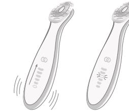
Nach zwei Minuten leuchten die Balken abwechselnd auf und erlöschen wieder, um den aktuellen Ladestand anzuzeigen. Sobald das Gerät vollständig aufgeladen ist, leuchten die Balken nicht mehr auf. Stattdessen schimmert die LED-Leiste nun kontinuierlich.
